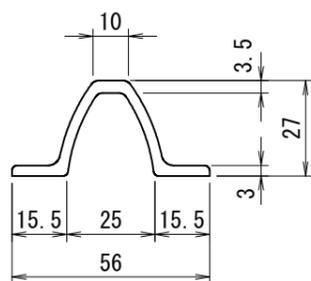
主柱断面図 (VA)
