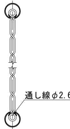
胴縁と金網取付断面図
