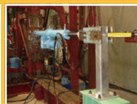
ベース式支柱の性能は、支柱の静荷重(曲げ)試験により検証しています。(左)支柱の変形状況。(右)静荷重試験：(財)建材試験センター
