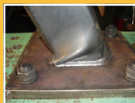
ベース式支柱の性能は、支柱の静荷重(曲げ)試験により検証しています。(左)支柱の変形状況。(右)静荷重試験：(財)建材試験センター
